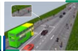
2. De réir mar a thagann an bus i bhfoisceacht, athraíonn an comhartha solais chun an trácht ginearálta a stopadh.
